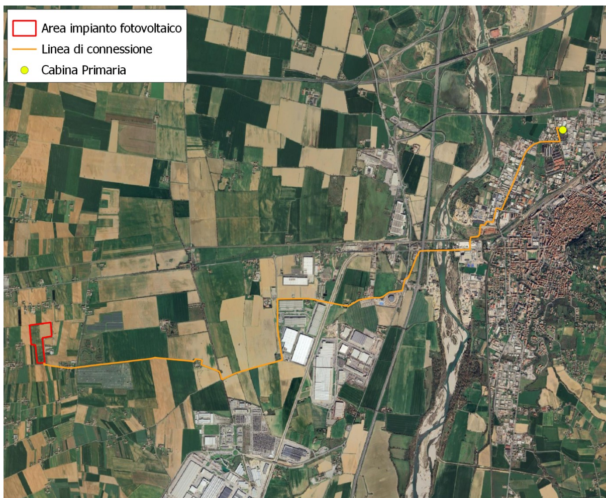
Figura 1 – Soluzione di allaccio dell'impianto FV "San Giuliano" (ubicato in sinistra idrografica del T. Scrivia) alla Cabina Primaria esistente nel comune di Tortona (ubicata in destra idrografica del T. Scrivia).
